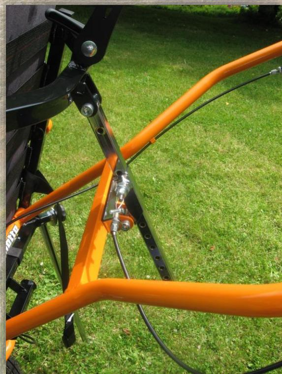
**Régler la hauteur des bras arrière avec l'aide de la poignée de gauche.**
