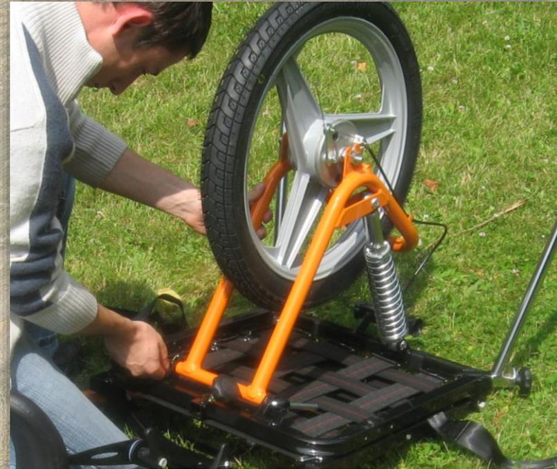
**Prendre la roue et son bras oscillant. Enlever la goupille de sécurité et retirer l'axe. Positionner la roue puis remettre l'axe dans son logement. Verrouiller l'axe et remettre la goupille**
