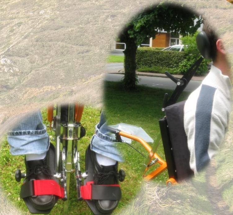
**Régler en hauteur et en profondeur les repose pieds. Installer la personne, fixer les pieds, régler l'appui-tête et boucler la ceinture de sécurité**
