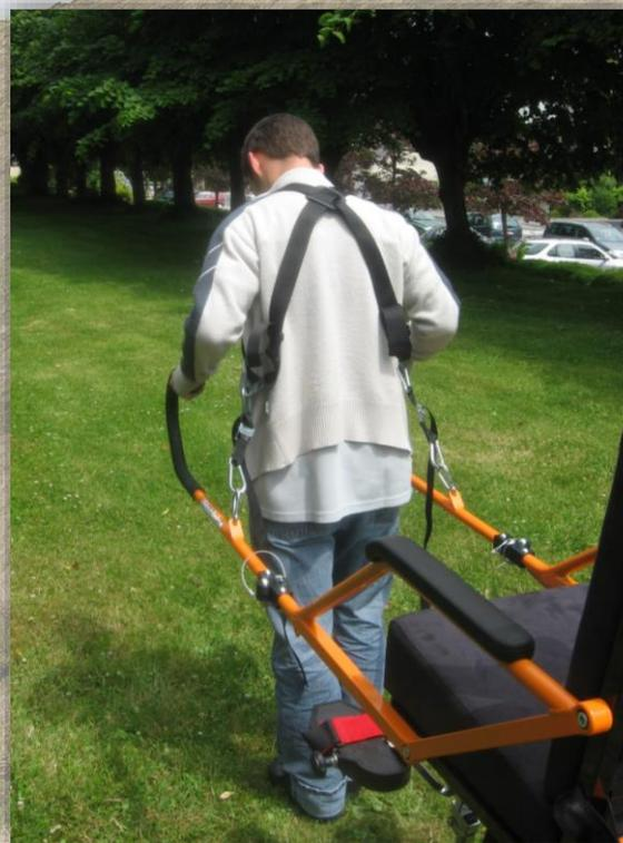
**Le harnais d'aide à la traction se fixe sur les mousquetons présents sur les bras avant. Faites un pré réglage des sangles. Il faudra les régler lorsque la Joëlette reposera sur sa roue.**
