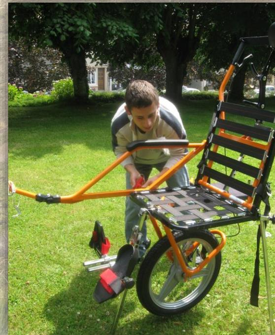
**Engager le boulon de l'accoudoir sur le dossier avec la clé fournie, de même pour l'assise ( ⚠ 3 positions d'inclinaison) et serrer les 2 boulons puis renouveler l'opération de l'autre côté.**
