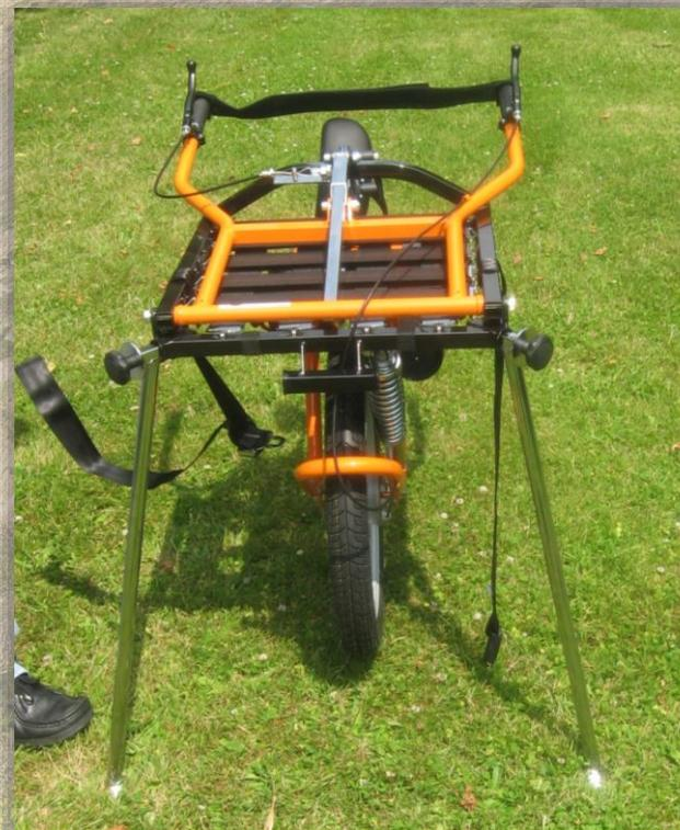
**Poser la Joëlette sur ses béquilles et vérifier le verrouillage de la béquille avant. L'ensemble tient alors sur son trépied.**
