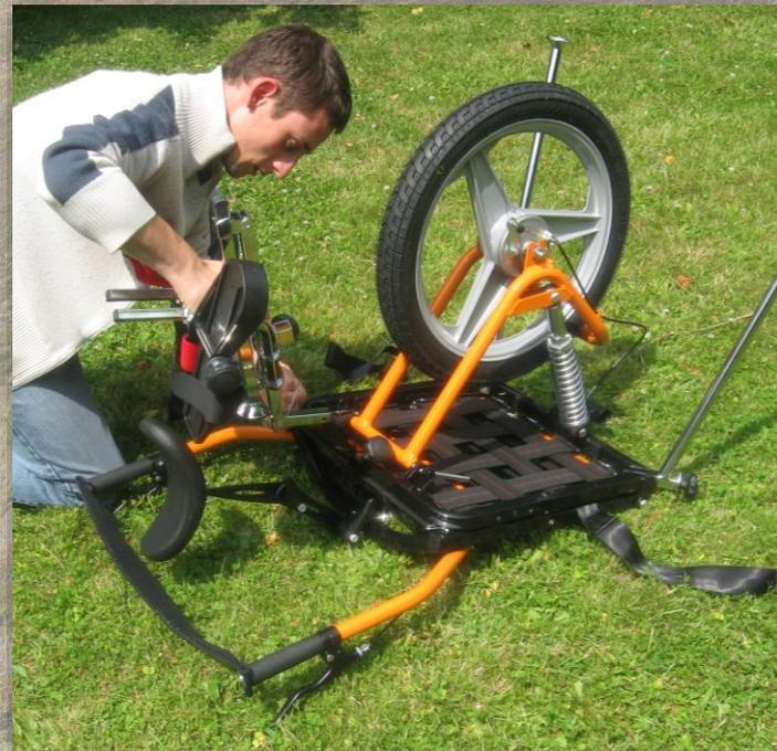
**Fixer la béquille avant, puis verrouiller la béquille avec la goupille de sécurité. Déplier la béquille et verrouiller la avec la bague de sécurité.**
